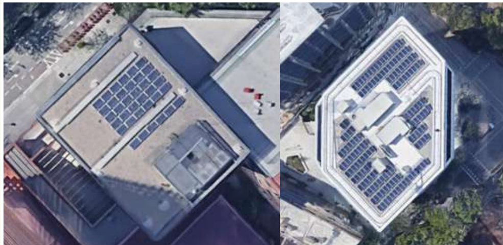
Figura 7.7. Instal·lacions d'autoconsum amb orientació simple.
